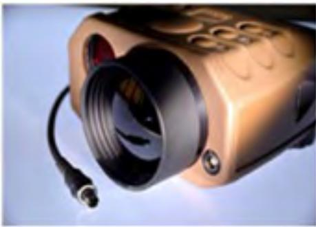
Fig 7. Termocamera con cavo da 10 Gbps
